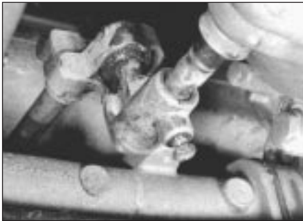
5.18 Shift rod coupling screw
