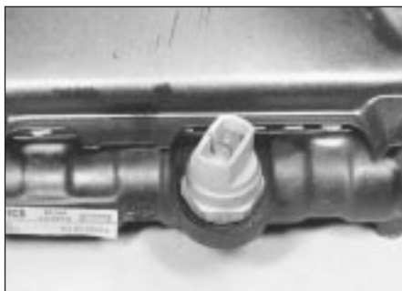
7.3 Cooling fan thermo-switch
